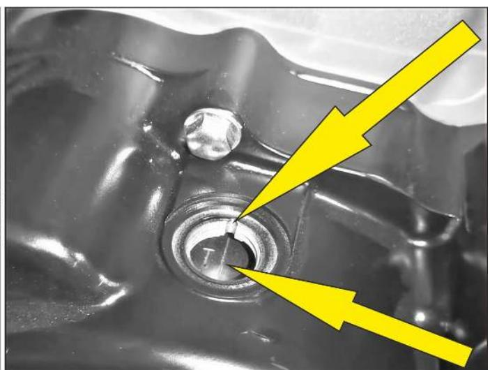
– Дополнительные метки находятся в головке цилиндра. Под крышкой (пробками) [2] на шестерне газораспределительного механизма находятся метки, которые должны совпасть аналогично нижним меткам ротора генератора.
